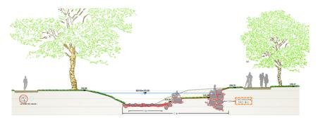
Il progetto consiste nella strutturazione del fondo dell'alveo con la posa di alcuni massi (trovanti calcarei) e del legno morto. In aggiunta è programmata la concretizzazione di sponde naturali con vegetazione riparia tipica e la piantumazione di diversi alberi (all'incirca 10) ad alto fusto e arbusti autoctoni sulle sponde.
